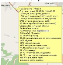
Параметры "КАМАЗа" (двигатель Cummins 6ISBe 210), полученные на стоянке: Зажигание включено
